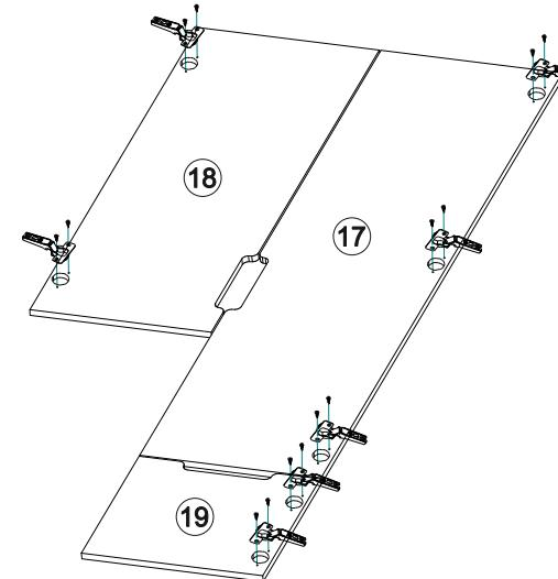
Регулирование зазоров и положения дверей с петлями
